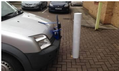
0,6m yüksekliğe monte edilmiş bir kameranın önünde kalan 1m uzunlukta direk
