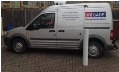
1,8m yüksekliğe monte edilmiş bir kameranın altında kalan 1m uzunlukta direk
